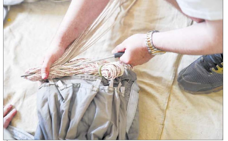
Для закрепления строп требуется специальный укладочный инструмент – крючок-вилка.
