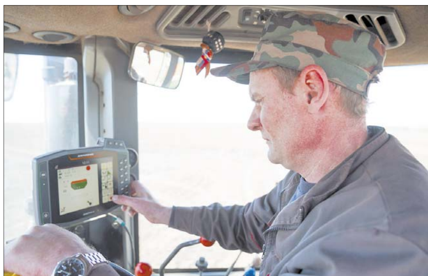
Механизатору Олегу Седову в работе помогает бортовой компьютер со спутниковой связью, который следит за всеми параметрами сеялки.
