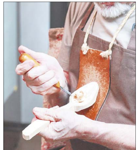
Парамошка – защитный элемент из толстой кожи, располагающийся на груди, при работе резакром.
