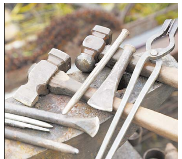
Необходимый минимум инструментов: клещи, молотки с бойками разной формы для придания объема и фактуры, фасонные зубила.
