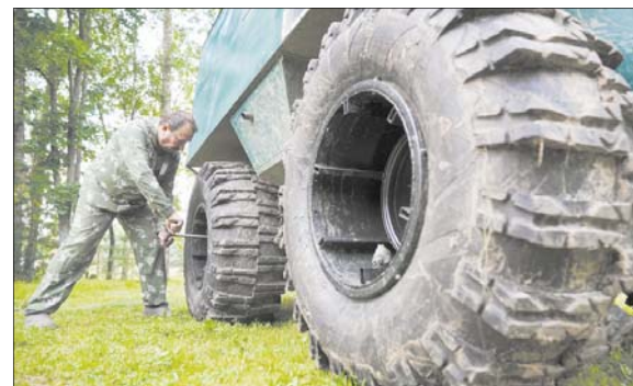
Для увеличения скорости вездехода-амфибии на воде Константин Яганов хочет прикрепить к дискам колес самодельные лопасти.
