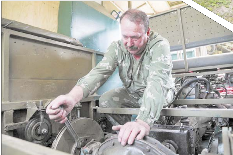
Трансмиссия внедорожника – это двигатель от "жигулей", задний мост от "Волги", самодельная коробка понижения скоростей, корзина сцепления от ГАЗ-53.
