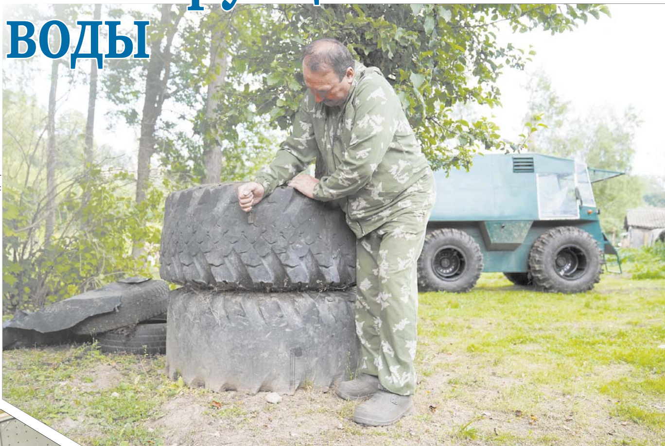
На вездеходе Яганова стоят колеса от грузовика "Урал". Каждое весит 161 кг. Чтобы облегчить вес, с колес сняли несколько слоев резины. Теперь вес одного колеса – 35 килограммов.
