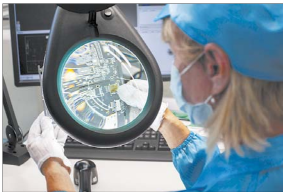
На современных платах элементы очень маленькие, при проверке на брак шуйские специалисты используют лупу с большим увеличением.
