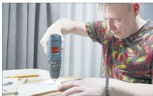
Чтобы вырезать в заготовке внутренний элемент, дрелью просверливают отверстие для пилки.
