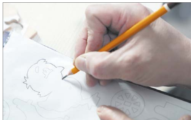
При переводе схемы деталей на фанеру используется копировка или рисунок, распечатанный на самоклеющейся бумаге.
