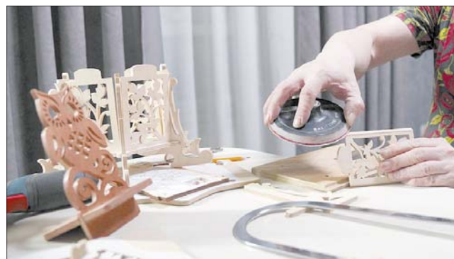
После шлифовки детали соединяются с помощью клея и покрываются лаком или морилкой.
