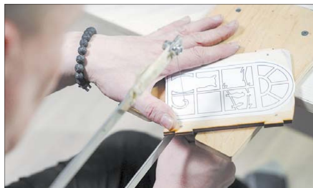
Для ровной линии лобзик необходимо держать только вертикально, двигать с минимальным усилием, при этом кисть должна быть расслаблена.
