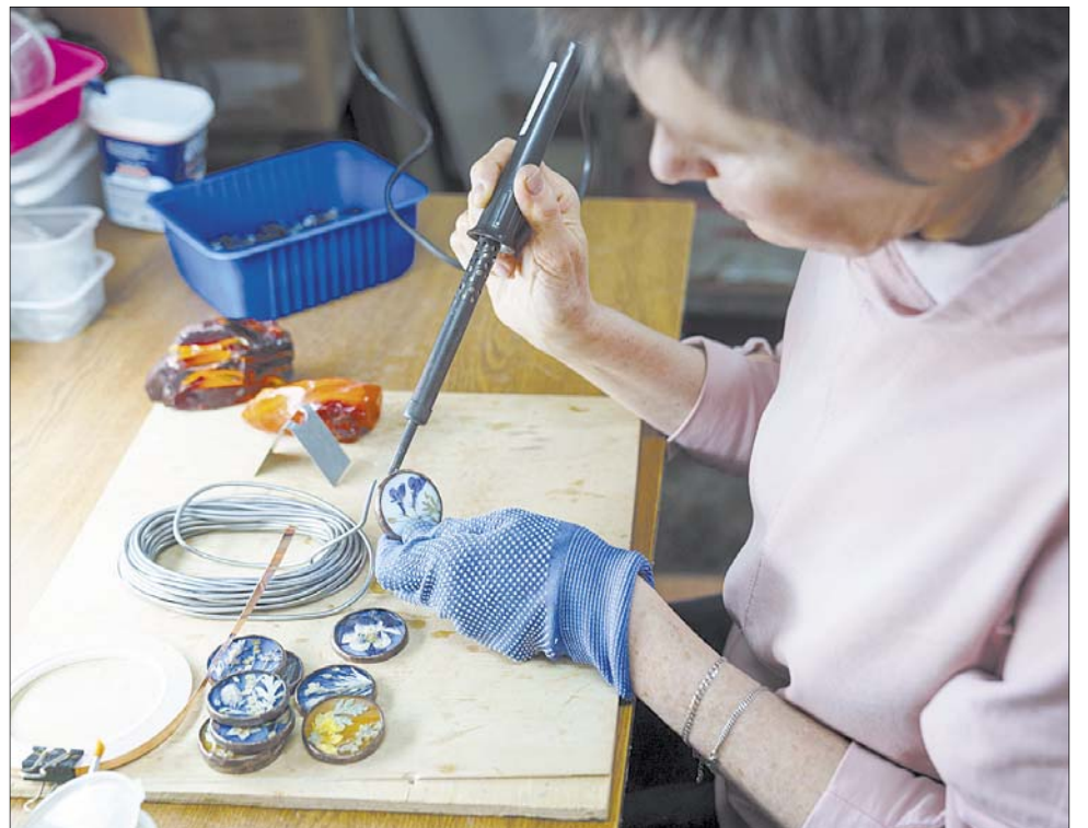
Техника "тиффани" – способ изготовления, при котором кусочки стекла соединяются между собой с помощью медной фольги. Цветы для кулонов Татьяна Махаева собирает сама.
