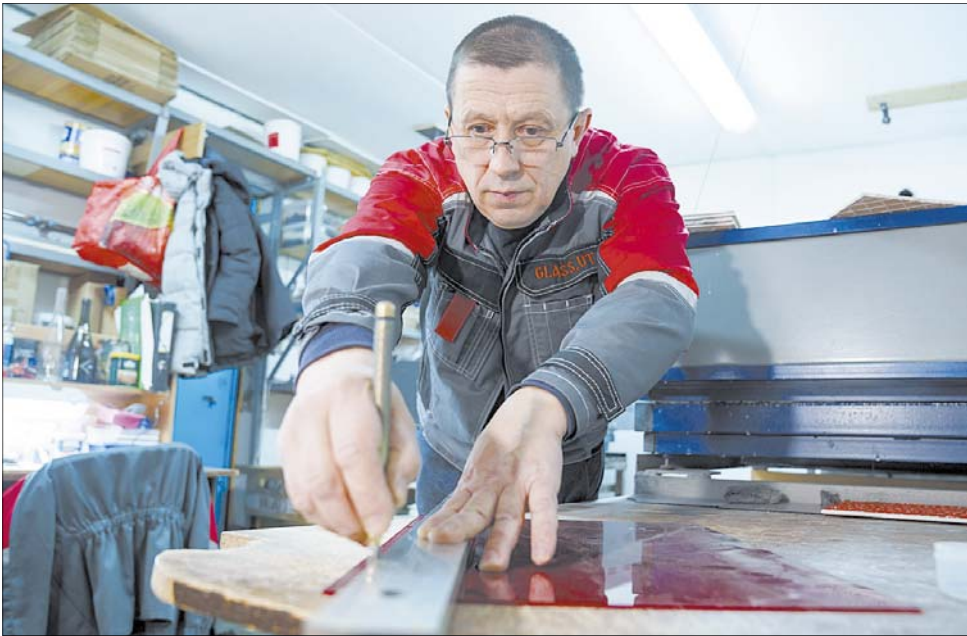
Стекло режут смачивают специальным маслом или керосином. Это улучшает качество реза, облегчает разлом стекла и продлевает срок службы инструмента.
