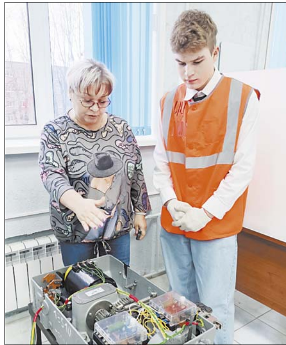
Тренажер "Управление стрелкой" повторяет конструкцию реальных устройств и программируется на любые неполадки, которые приходится устранять студентам.
