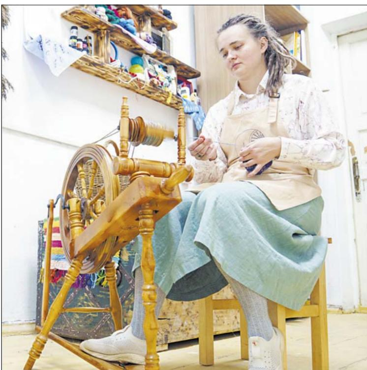
Сучивание (соединение нескольких нитей) выполняют на механической самопрялке – той, что как раз изображена на гербе Иванова.
