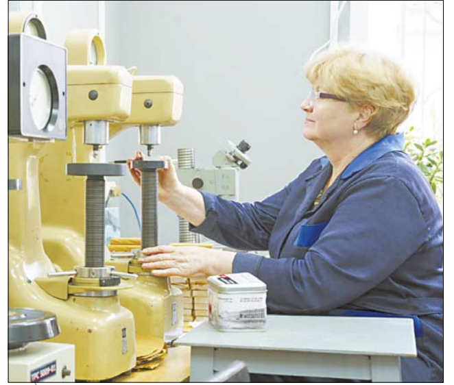
Нина Смирнова уже 50 лет работает в лаборатории мер твердости. Эталонные меры применяются при проверке и калибровке приборов.
