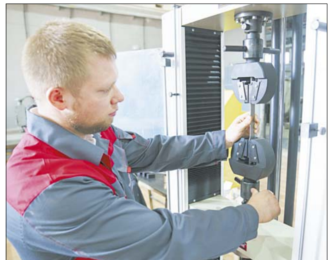
В Иванове выпускают испытательную универсальную машину. На ней можно проверить материал на растяжение, сжатие, изгиб.
