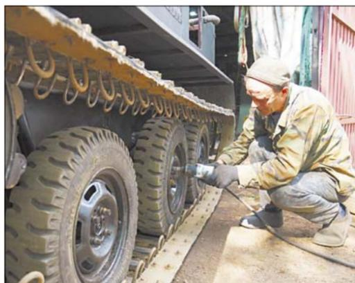
Движение обеспечивает резинометаллическая гусеница. Опорные катки – от "Жигулей", а вот покрышки взяты от специализированной строительной техники.
