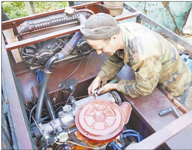
В вездеходе на 99% – запчасти от отечественных машин: например, коробка передач и двигатель – от "Лады 21083"...
