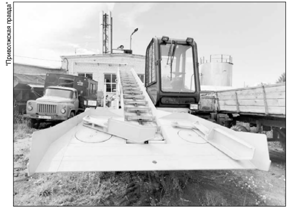
Лаповый снегопогрузчик позволяет убирать с дорог до 350 кубических метров снега за час.
