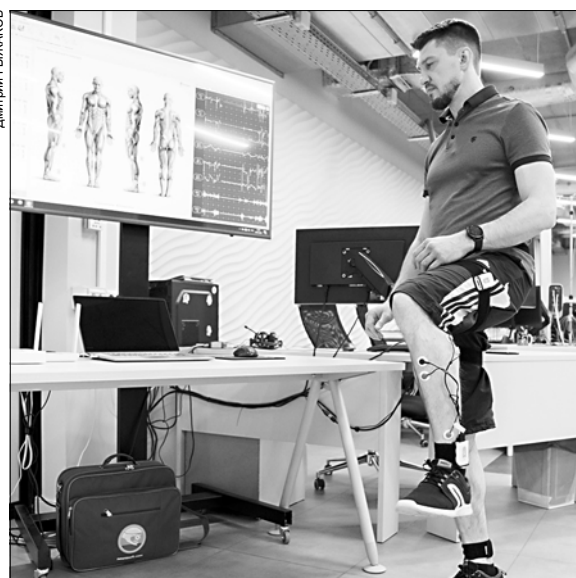
Ивановская система "Стэдис" анализирует длину шага, работу суставов, позволяя врачам подобрать схему реабилитации.
