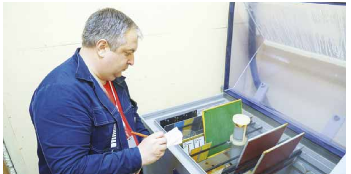
Камера солевого тумана определяет антикоррозионные свойства будущего покрытия.
