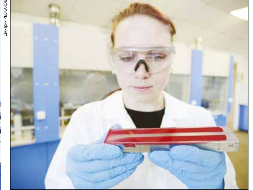
Гридометр используется для контроля степени измельчения. Чем меньше размер частиц, тем лучше перетерт материал. Это ведет к улучшению качества поверхности.
