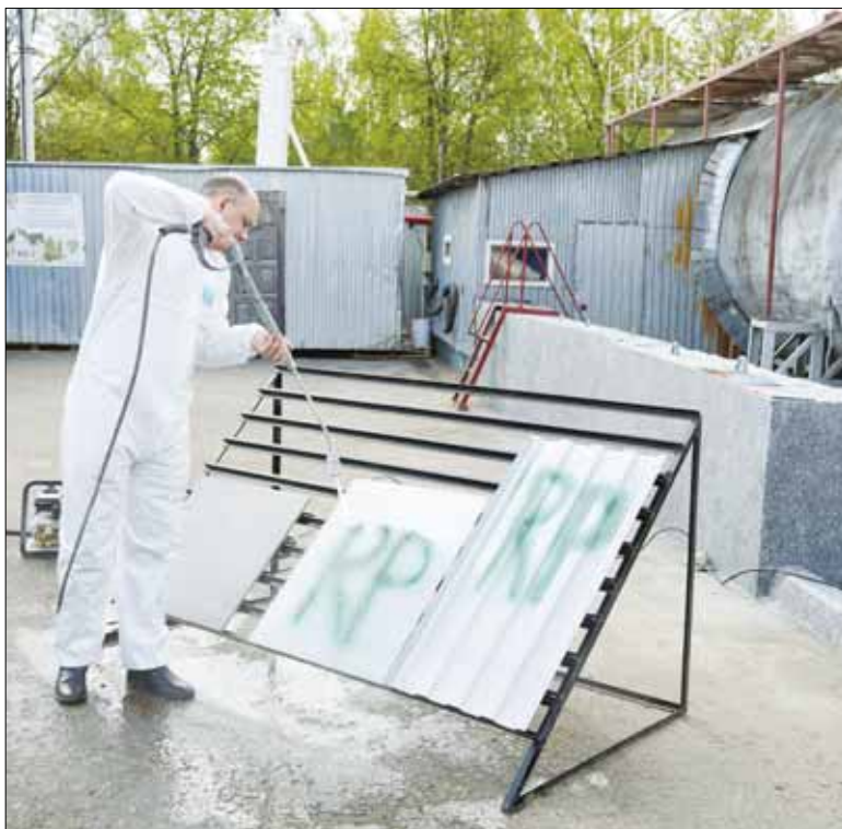
Защитное антивандальное покрытие на испытаниях. После обработки поверхности этим составом граффити легко смываются, а приклеенные объявления можно снимать без лишних усилий.
