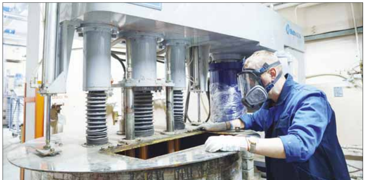
Мельница перемалывает и смешивает компоненты при помощи керамического бисера.
