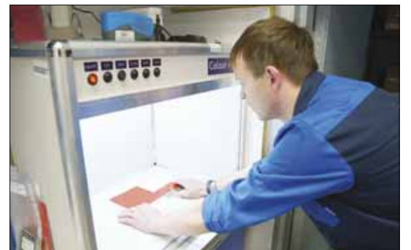
Чтобы оттенок лакокрасочного материала был одинаковым в каждой партии, его сравнивают с эталоном в лампе колориста.
