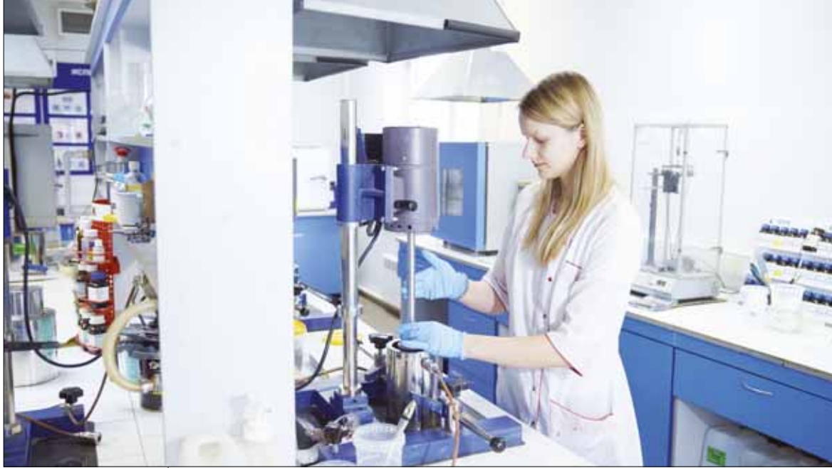
Процесс диспергирования – тонкое измельчение пигментов и наполнителей до фракций, соответствующих ТУ.
