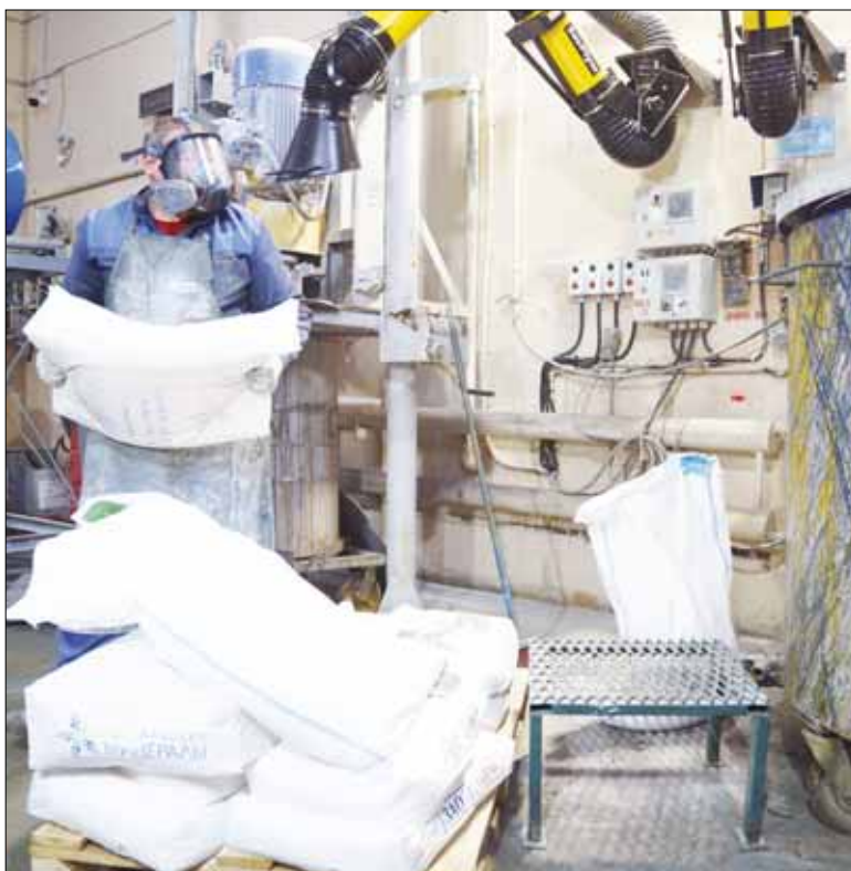
На участке смешивания в смолу и раствор добавляют различные сыпучие компоненты, например микрокальцит.
