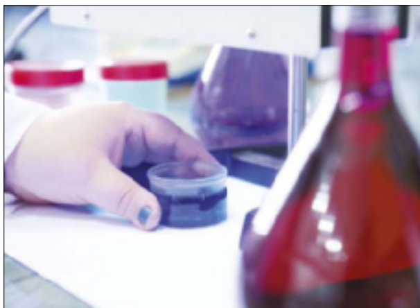
Под воздействием ультрафиолета раствор оксида вольфрама темнеет. Тонкие пленки, обработанные таким раствором, – перспективный материал для затемнения автомобильных стекол, очков.
