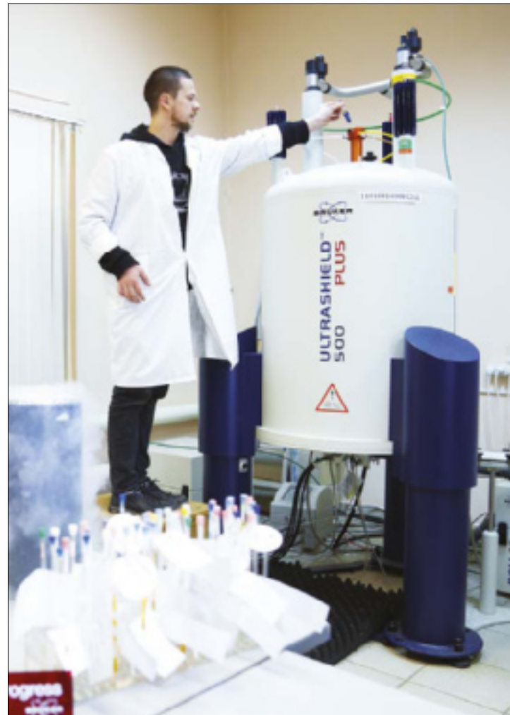
Спектрометр Ядерно-магнитного резонанса используется для наблюдения за процессами, протекающими в растворах на молекулярном уровне.
