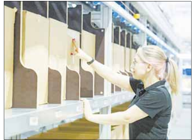
С помощью автоматки каждая вещь попадает в нужную коробку, работнику остается только подтолкнуть ее, чтобы она отправилась в пункт выдачи.
