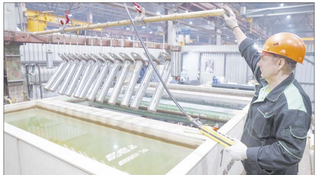
Достаточно оцинковать ось всего в один микрон, чтобы увеличить коррозионную стойкость металла в три раза.
