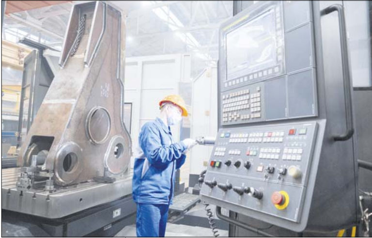
На горизонтально-фрезерном центре с высокой точностью обрабатываются крупногабаритные детали.
