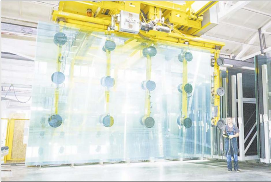
Стекло транспортируют с помощью специального устройства на вакуумных присосках.
