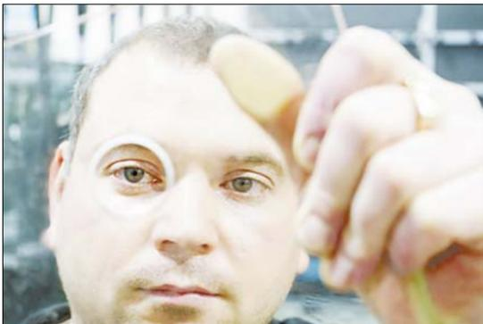
Зенкование отверстия упрощит монтаж, уменьшит опасность порезаться.
