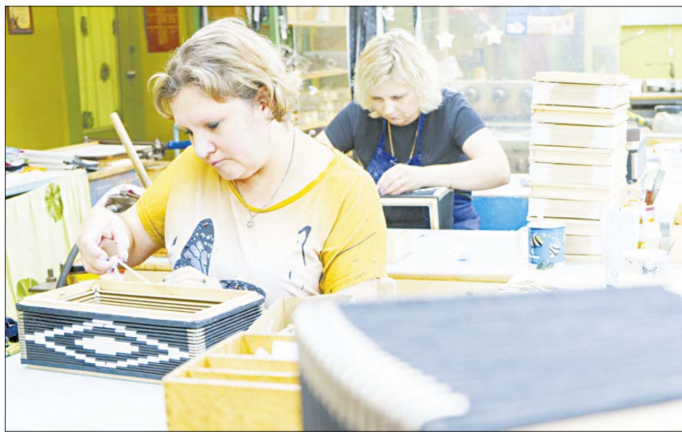
Ювелирная работа — монтаж голосовых планок растопленным воском.
