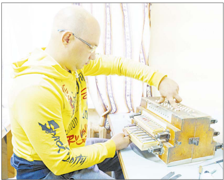
Предварительная настройка возможна только по резонансу с использованием напильника и голосника.
