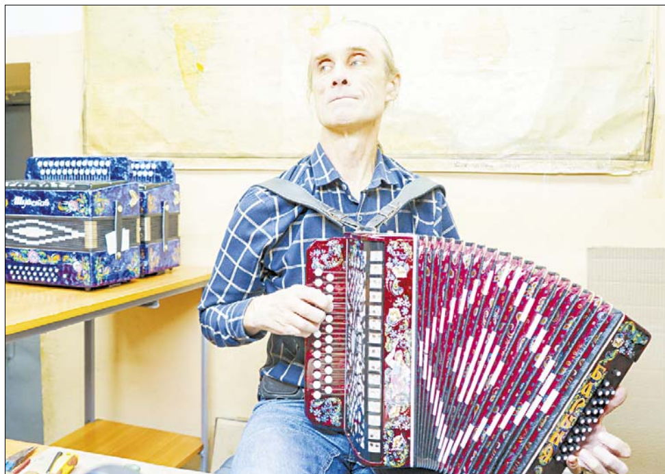
Проверка изделия — завершающий этап. Оценивается качество звучания и целостность корпуса.
