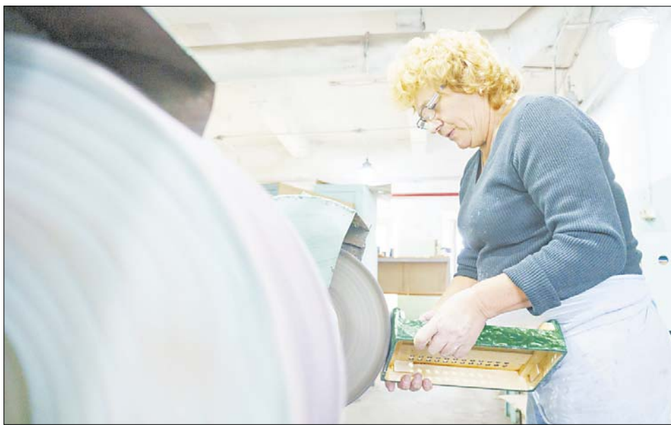
После деревообработки корпус поступает в белом виде. Нанося специальное масло, рамку начинают полировать.
