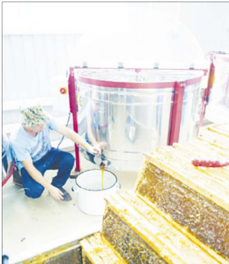
Медогонка с помощью центробежной силы выкачивает мед из рамок.
