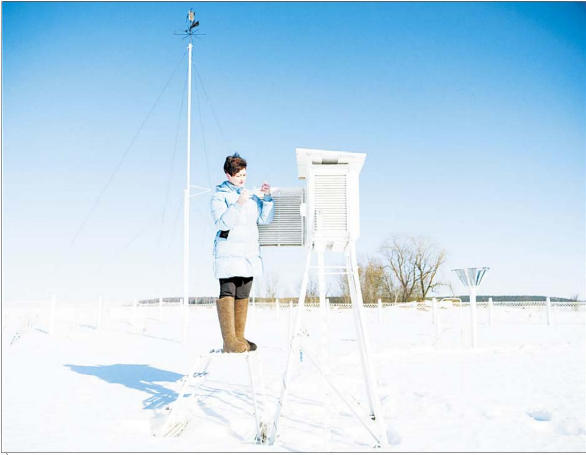
На метеоплощадке в Шуе множество приборов: психрометрическая будка, осадкомер, флюгер, гололедный станок, почвенные термометры...
