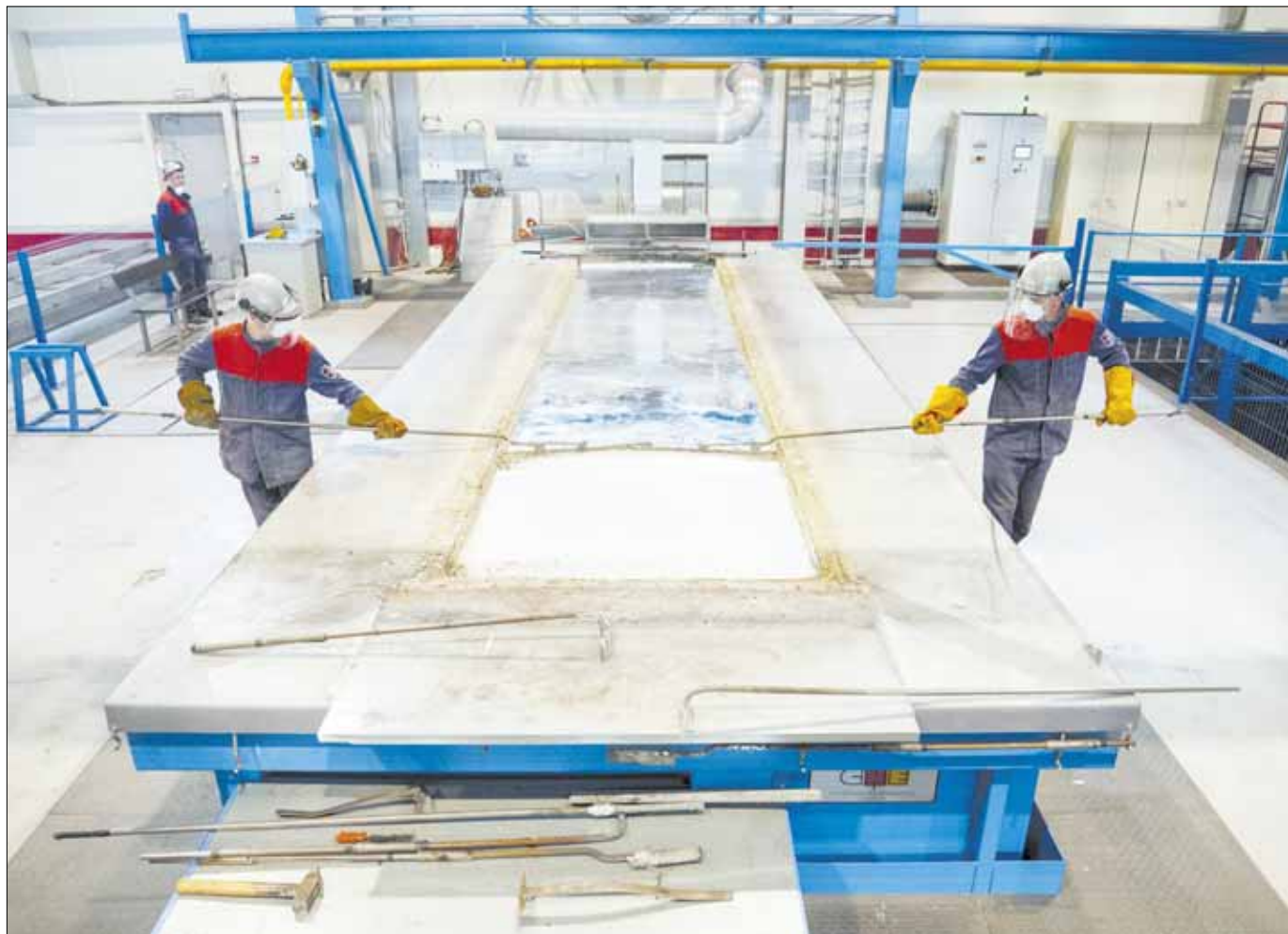
С расплавленного цинка перед погружением металлоизделий в ванну работники снимают оксидную пленку.
