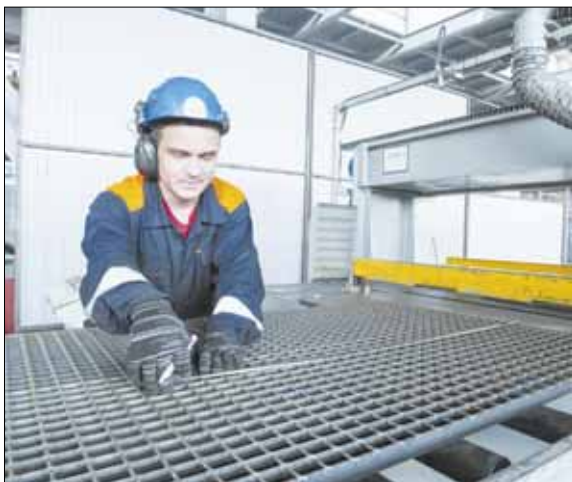
Решетчатый настил используется повсеместно — от нефтегазовых платформ до грязезащитных решеток перед входами в торговые центры.
