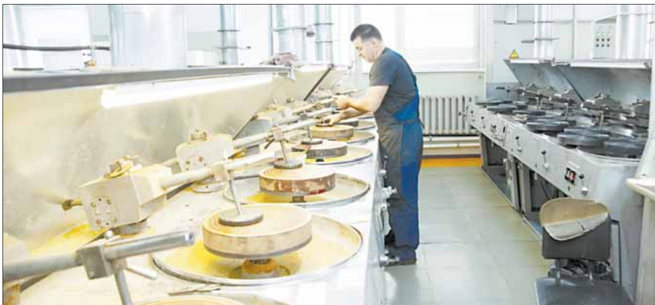
Полировка пластин алмазной пастой.
