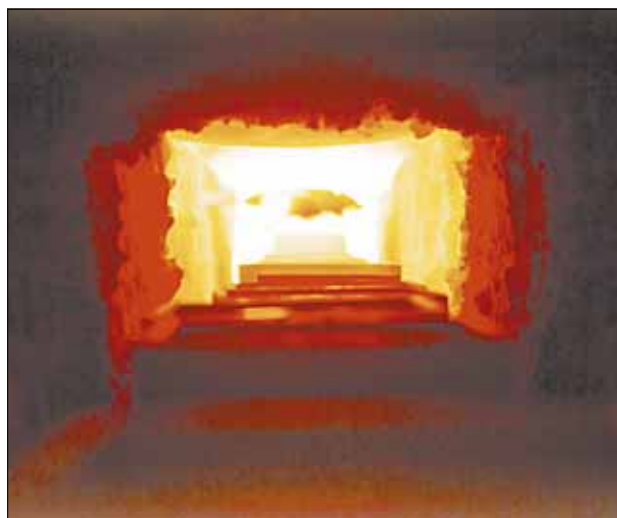
На обжиг иногда требуется семь дней, а температура в печах может достигать 1750 градусов.
