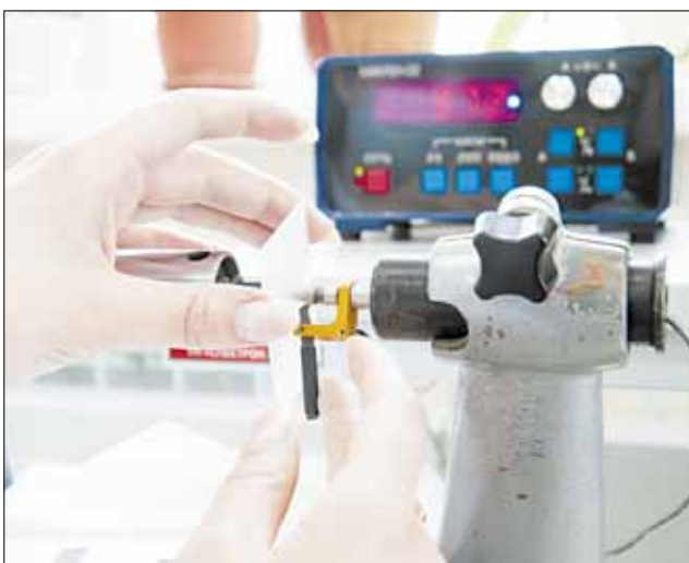
Проверка готовых пластин на диэлектрическую проницаемость.
