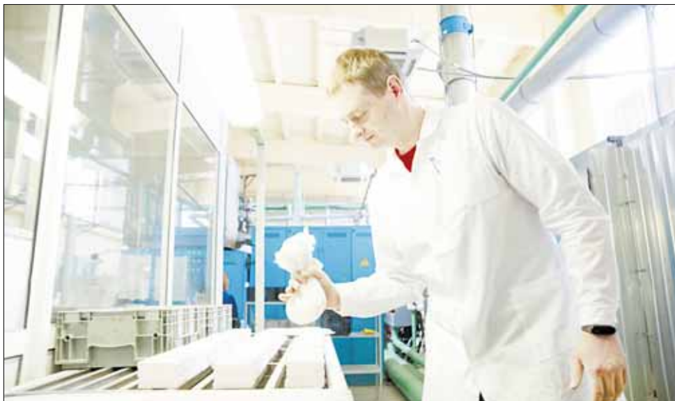
Пересыпка шлифзерном, чтобы пластинки не спеклись.
