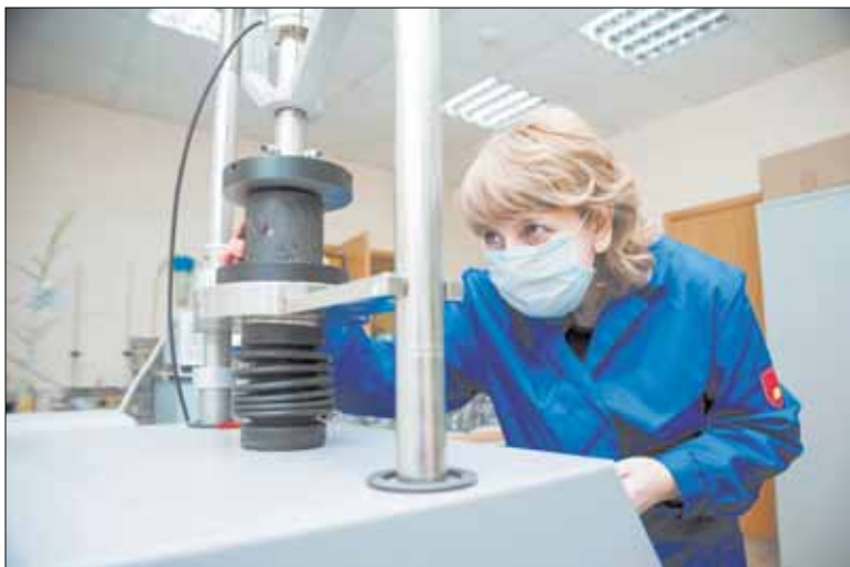
С помощью пресса определяют предел прочности асфальтобетонной смеси.
