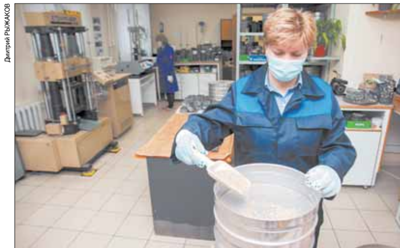
Чтобы определить соответствие нормативам, песок и щебень просеивают через специальные сита.
