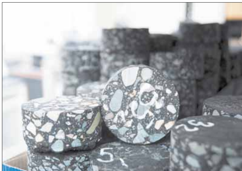
Керны — это пробы, которые берутся для определения качества выполненных работ.
