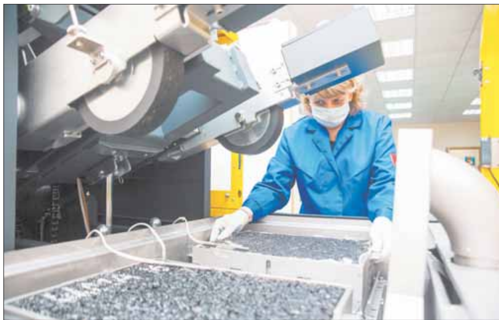
Прокатывание "тяжелым" колесом в течение шести часов — испытание на устойчивость к образованию колеи.
