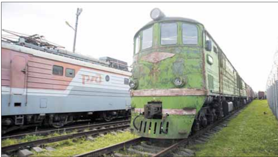
Одна из самых старых машин в Ермолине: именно тепловоз ТЭ-3 в свое время пришел на смену паровозам.
