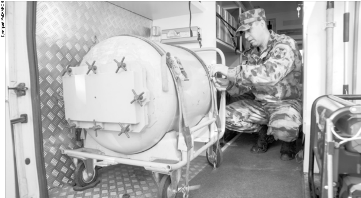
Если в таком контейнере во время перевозки что-то взорвется, люди не пострадают.
