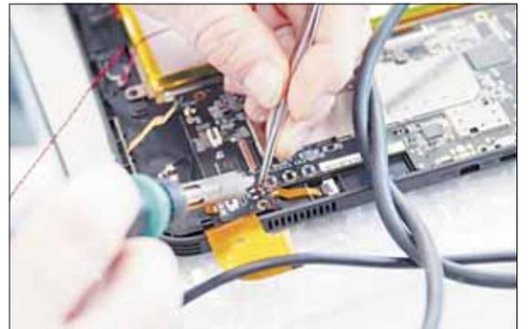
Пайка GSM-антенны, необходимой для усиления сигнала.
