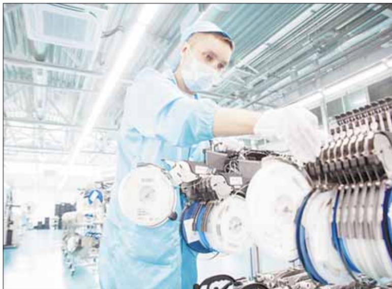
Резисторы, разъемы, конденсаторы для плат находятся в специальных катушках.
