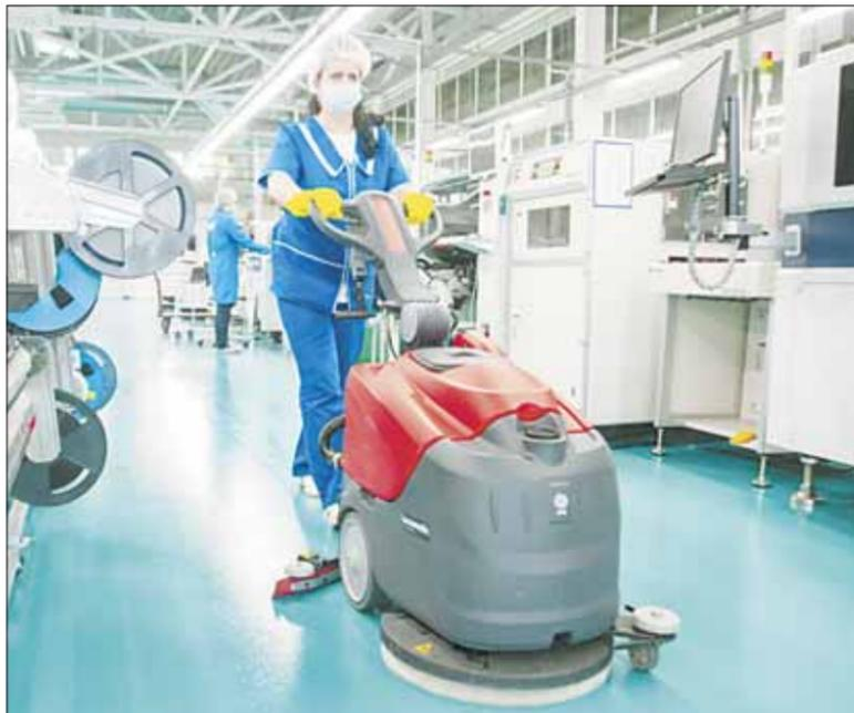
В цехе монтажа, чтобы в микросхемы не попадали мелкие частицы, влажную уборку проводят два раза в день.
