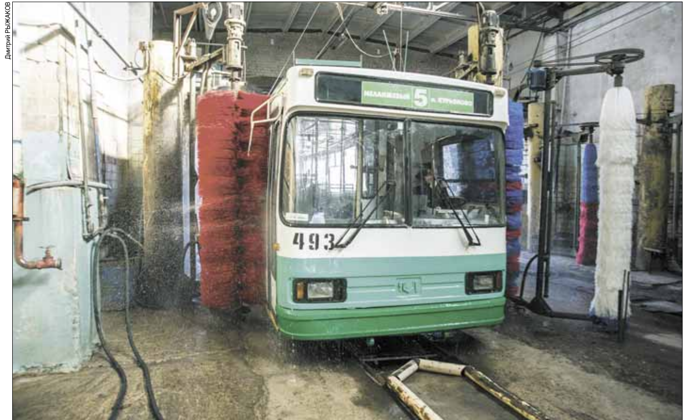
Сначала троллейбус проезжает через щеточную установку.
