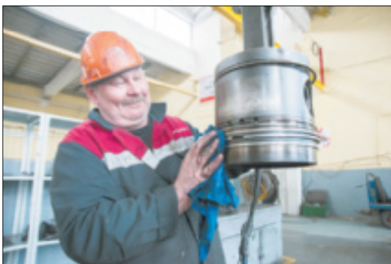
Слесарь Василий Рукшин проверяет поршень из двигателя тепловоза (вес детали — 19 килограммов).
