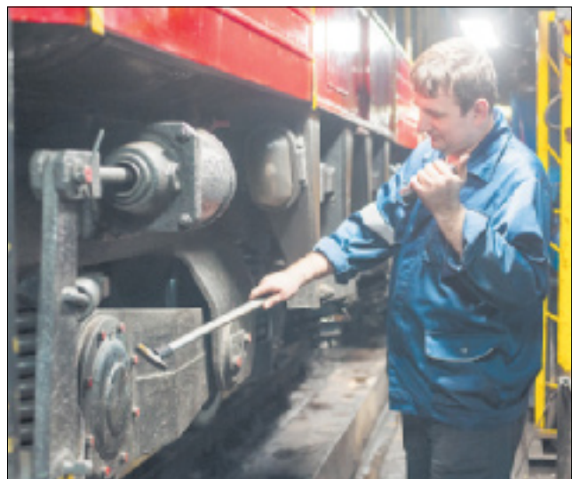
Приемщик Андрей Бибик принимает локомотив после ремонта (проверяет протяжку болтов).
