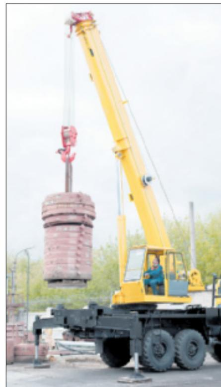
Перед тем как кран поступит в продажу, его ждут многочисленные испытания и проверки.
