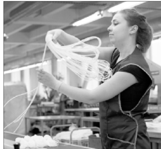
Одна часть строп идет на укрепление купола, другая — служит для его соединения с подвесной системой.
