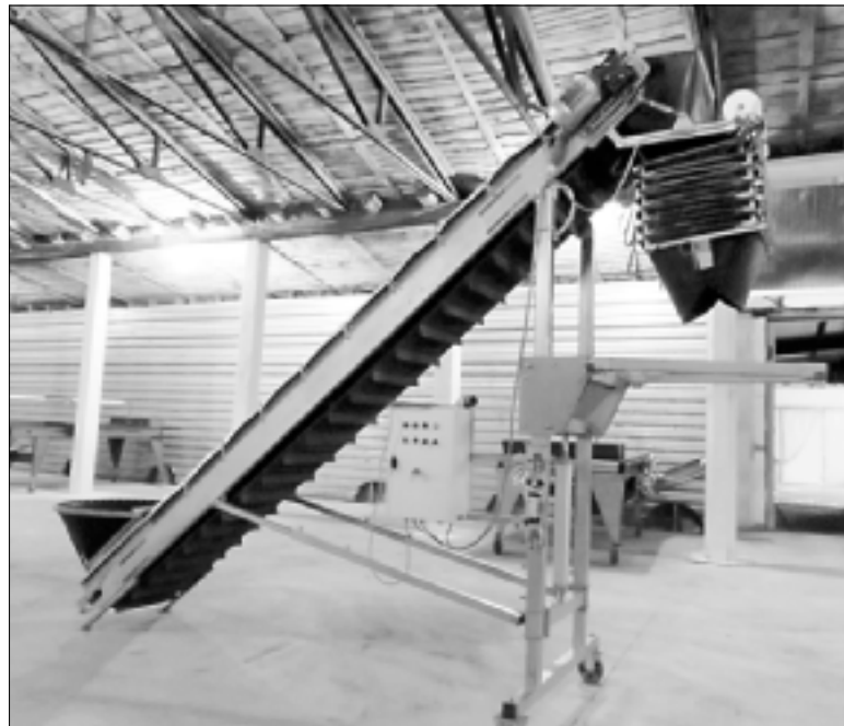
В хозяйстве много современной техники. Специальное устройство фасует корнеплоды в мешки.
