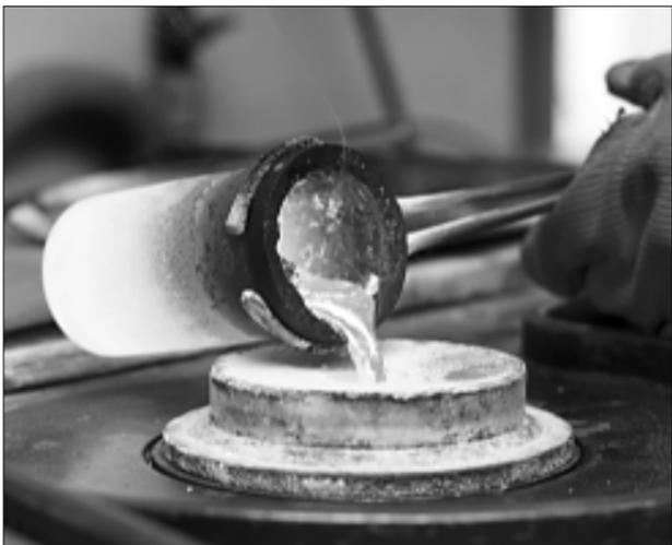
Расплавленный металл заливают в подготовленную форму.
