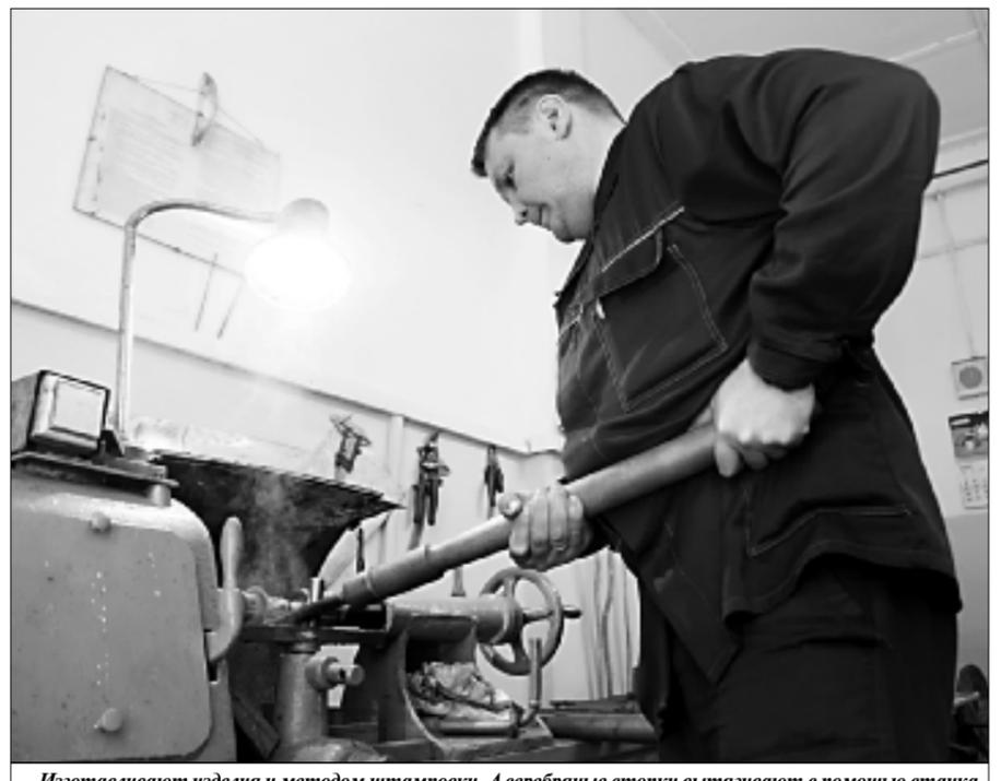
Изготавливают изделия методом штамповки. А серебряные стопки вытягивают с помощью станка и форм, на которые, как масло по хлебу, специальным инструментом раскатывается металл.
