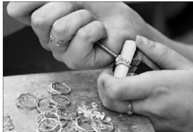
Большинство камней закрепляют вручную.
