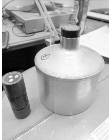
▲ Адсорбент и емкость для его помещения в спектрометр при исследовании радона.
