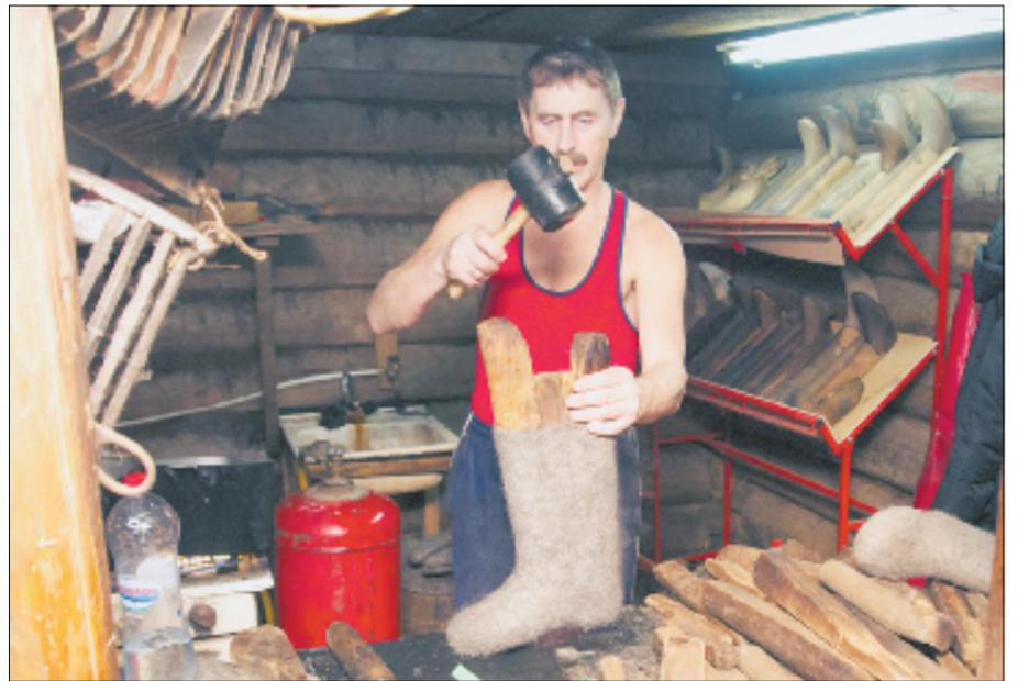
Нужный размер придается с помощью колодок, и на 12-15 часов обувь отправляют на сушку.
