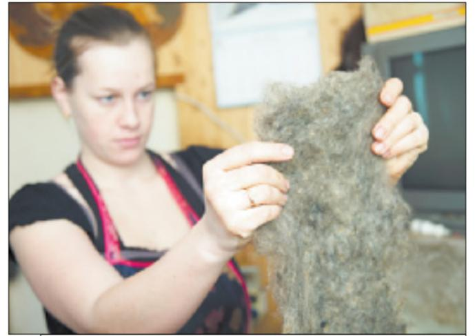
Раскладка шерстяного полотна для будущих валенок – самый ответственный этап. Если слой не получится равномерным, валенки выйдут разной толщины и быстро испортятся.
