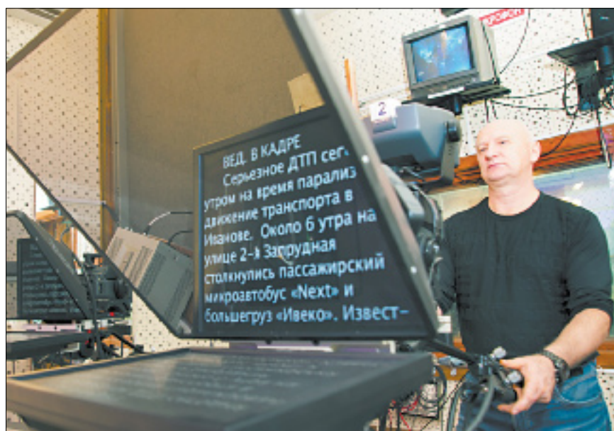
Главный помощник ведущего — телесуфлер, установленный на видеоканере.
