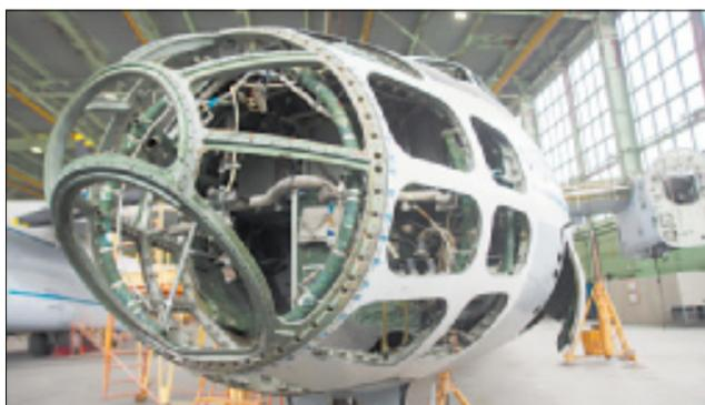
▲ В ангаре ремонтного цеха № 1, что у Северного аэродрома, самолеты разбирают. В их конструкции обнаруживают дефекты и ремонтируют. Тут же при необходимости снимают агрегаты и их блоки. После ремонта, сборки всех узлов и покраски наступает череда наземных испытаний, а затем и летных. Только потом самолет возвращают в эксплуатацию.
