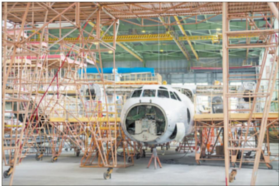
▲ Эти леса и стапелы – малая часть специального оборудования, позволяющего работать с огромными машинами.
