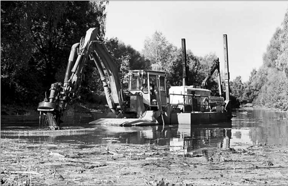
▲ Земснаряд, который применяется при расчистке русла, напоминает помесь парохода с экскаватором.
