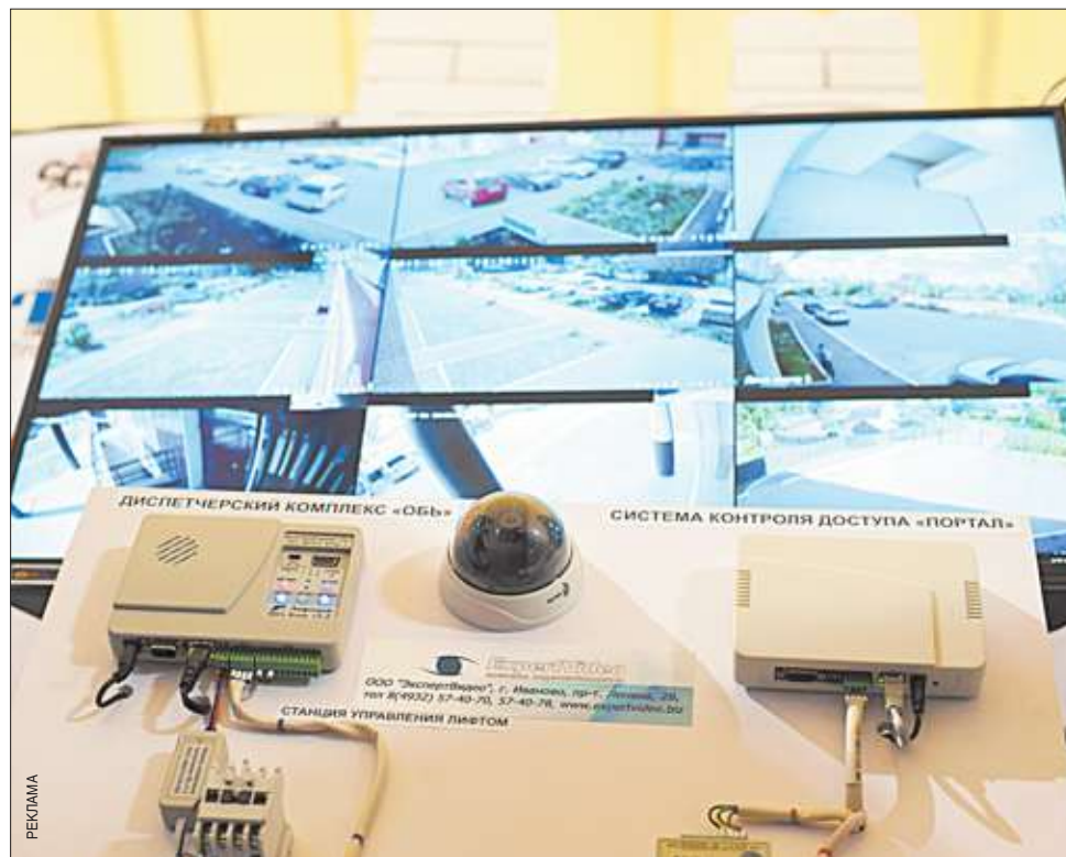
Диспетчерский комплекс «Обь» позволяет дистанционно следить за состоянием лифта в режиме онлайн.
