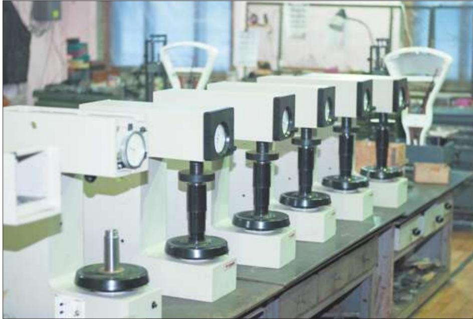
Приборы для измерения твердости металлов по Роквеллу TR 5006M.
