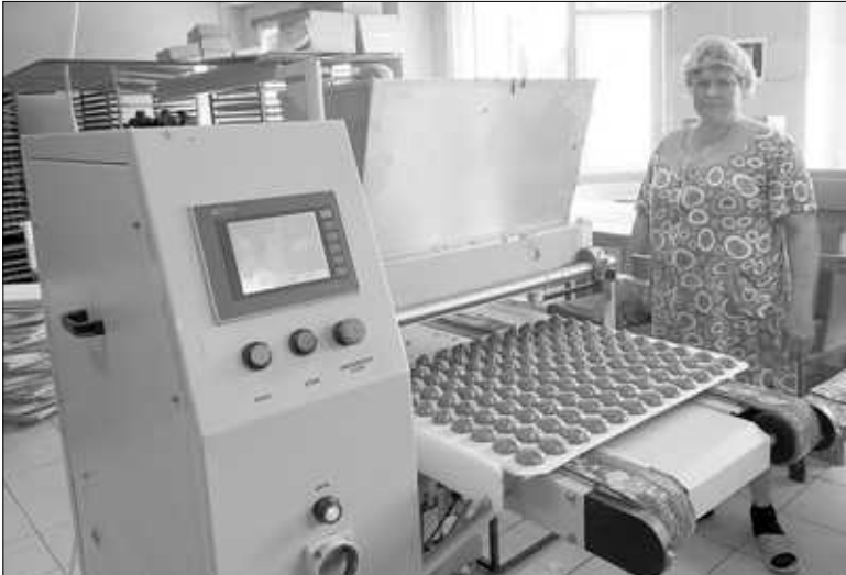
▲ Процесс отсадки «Театральной помадки» автоматизирован.
