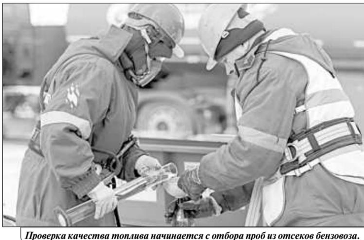
Проверка качества топлива начинается с отбора проб из отсеков бензовоза.
